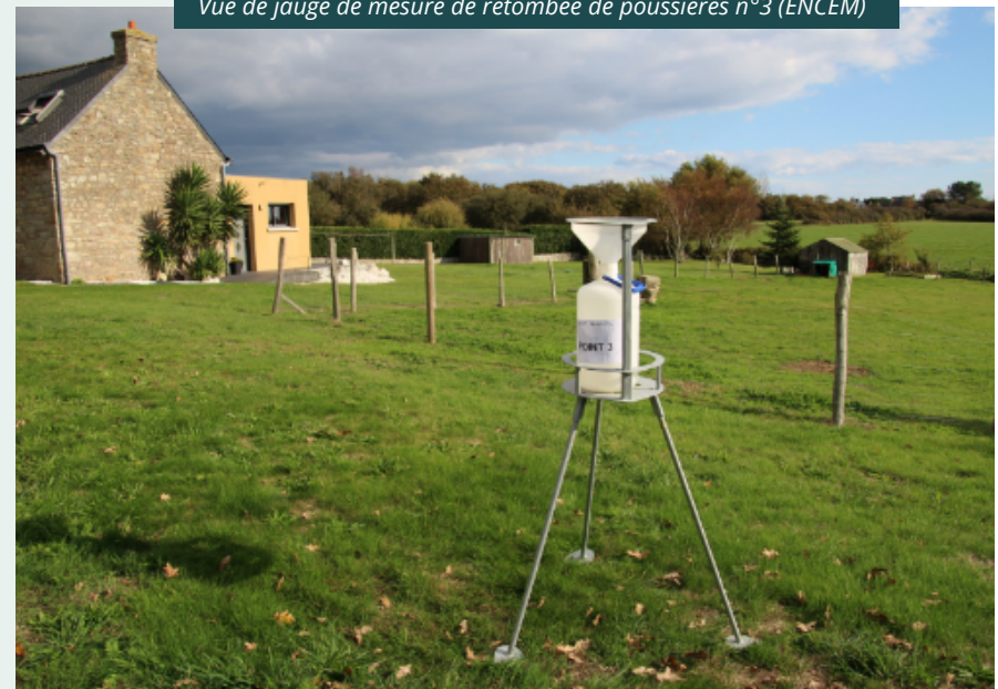
Vue de jauge de mesure de retombée de poussières n°3 (ENCENM)
